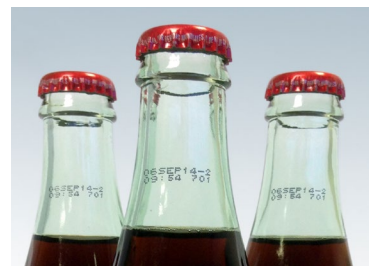
Coding above the fill line
